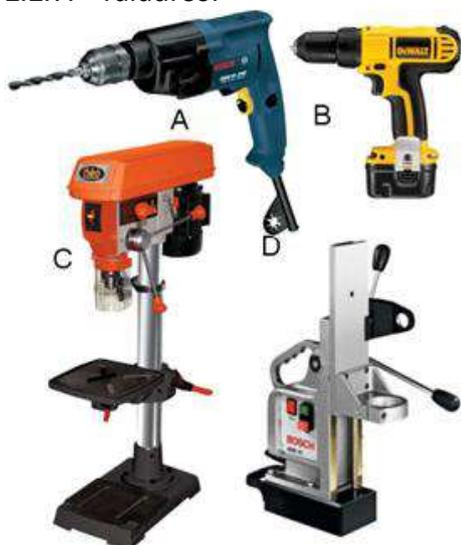
Al igual que ocurre con las amoladoras, los hay portátiles, con conexión a la red eléctrica (A), o de batería (B). También hay taladros de mesa, que van fijos al banco de trabajo (permiten realizar perforaciones de gran precisión). Incluso, existen bancos (D,) en los que se puede acoplar un taladro portátil, para transformarlo, momentáneamente, en uno de mesa.
