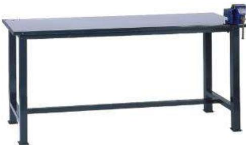
Para trabajar con comodidad, es imprescindible contar con un banco al que se le debe de dotar de un gato o mordaza, para poder sujetar las piezas que requieran ser taladradas, cortadas o soldadas. Nos permite trabajar sin necesidad de agacharnos. Normalmente, se trata de bancadas de metal, que soportan gran cantidad de peso, por esta razón, podremos depositar sobre ellas aperos, máquinas de mediano tamaño e incluso motores enteros.
