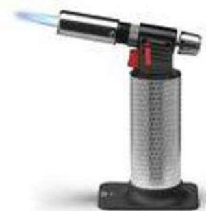
El soplete realiza soldadura blanda, en fontanería por norma general. Utiliza el estaño o el plomo como elemento de unión, cuenta con un regulador de llama que nos permite fundir el metal para sellar ranuras. En fontanería se usa para unir piezas especiales (codos, machones, enlaces, etc.) con la tubería.
